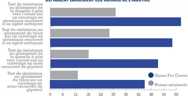
Test EN ISO 13287:2012 pour déterminer la résistance au glissement, effectué par TÜV Rheinland LGA Products GmbH à Leipzig, en Allemagne, en août 2018. \* Sur une échelle où 0,0 correspond à l'absence de friction et 1,0 correspond à une très forte friction (par ex. un tapis sec), SFC a enregistré 0,63, soit plus de trois fois la norme minimale de 0,18. Toutes les chaussures SFC sont équipées de la semelle extérieure antidérapante brevetée Shoes For Crews. Produit testé: BRIDGETOWN 28740
