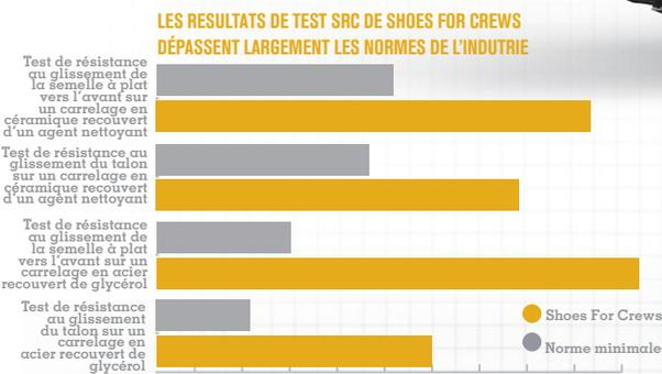
Test EN ISO 13287:2012 pour déterminer la résistance au glissement, effectué par TÜV Rheinland LGA Products GmbH à Leipzig, en Allemagne, en août 2018. \* Sur une échelle où 0,0 correspond à l'absence de friction et 1,0 correspond à une très forte friction (par ex. un tapis sec), SFC a enregistré 0,63, soit plus de trois fois la norme minimale de 0,18. Toutes les chaussures SFC sont équipées de la semelle extérieure antidérapante brevetée Shoes For Crews. Produit testé: DOLCE81 76236
